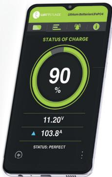
Im **ersten Reiter** ist der Ladezustand (Status of Charge), die außen anliegende Batteriespannung sowie die Akkukapazität dargestellt.
